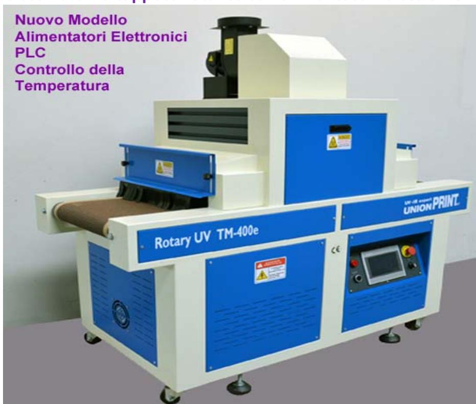
**Modello Rotary UV TM-400e progettato per essere impiegato per il trattamento UV incollaggio delle suole in EVA come pure una vasta gamma di prodotti che richiedono un trattamento UV**
